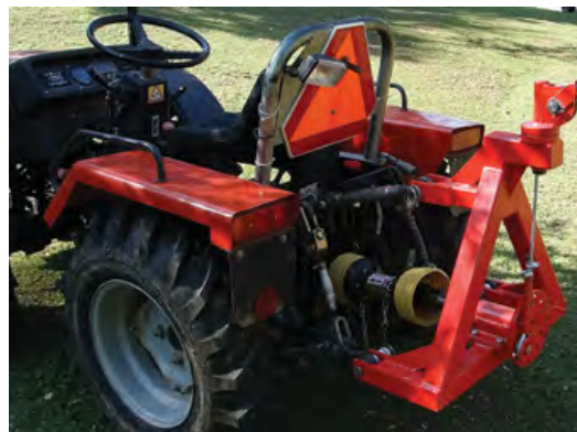
Mechanismus na třepání trnek
